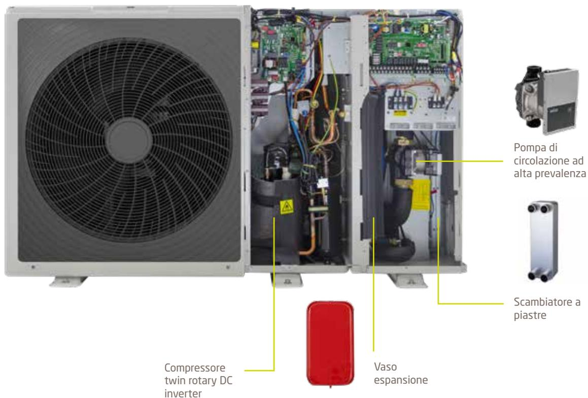
**Compressore twin rotary DC inverter:** completo di protezione termica interna e resistenza carter, montato su gommini antivibranti e avvolto su cuffia isolante per ridurre la trasmissione di rumori e vibrazioni dovute al funzionamento.
